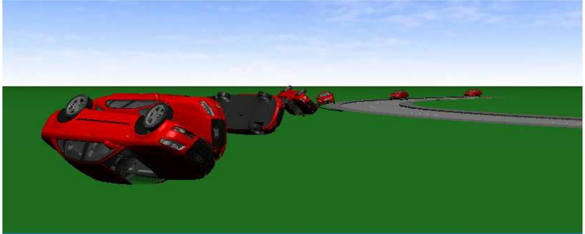
В программе применяется математическая модель водителя, предназначенная для обеспечения движения транспортного средства по заданной траектории (в зависимости параметров его движения АТС, характеристик опорной поверхности и критериев математической модели водителя).
